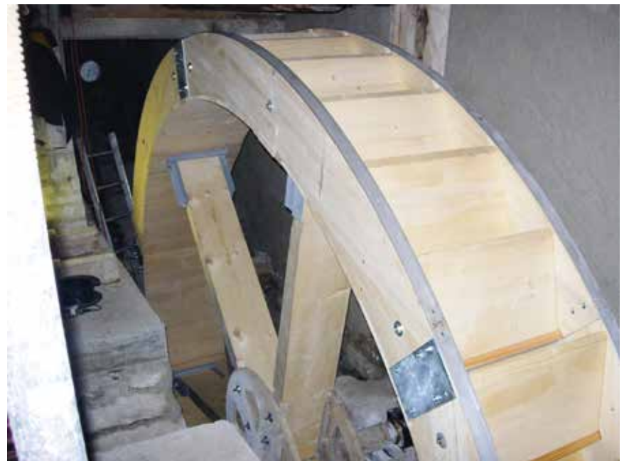
Pour le moment la roue à augets du moulin de Bayerel tourne peu, faute de débit suffisant. La récupération des eaux de drainage de la Côtée devrait changer la donne. (Photo: Moulin de Bayerel)
