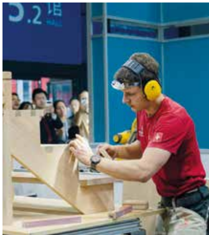
Augustin Mettraux a dû réaliser un escalier en colimaçon composé de pièces cintrées (photo SwissSkills).
